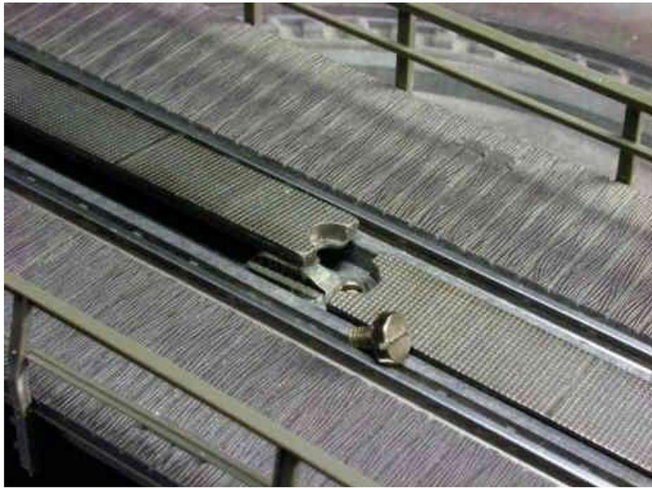
Nous avons maintenant complètement libéré le pont de son ancrage dans la fosse et pouvons le retirer pour révéler tout le mécanisme du moteur, de l'enrouleur, de la glissière, etc. en dessous.
